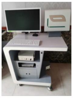
中医设备模型在中医诊断教学中用到的工程学方法,重点构建了一个符合人体构造的运动的流体实物模型,在 此基础上开发了一套针对中医诊断教学的模拟系统一中医脉象发生仪。该系统将中医学与仿生学、机械学、传 感技术及计算机技术等工程学方法结合起来。机械系统设计合理,噪音小,用电泵、管道循环系统和电磁阀模 拟了人体心脏和血液循环系统。用高性能的单片机处理器和外面控制电路一起实现了键盘控制、液晶显示、无 线发射接收和机械系统控制等功能。键盘操作简单,外观设计科学。软件系统和硬件系统有很大的升级和改进 空间,方便拓展更多脉象。通过多种方式对脉搏信号提取,经过信号处理电路得到脉象图结果,与实际脉象图 比对,得到好的效果。
